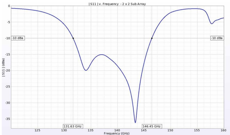
図5：ベース素子の2X2スロットアンテナのリターンロス 2X2アンテナ素子のリターンロスは、約132GHzから146GHzにかけて-10dB以下の良好な性能を示している
