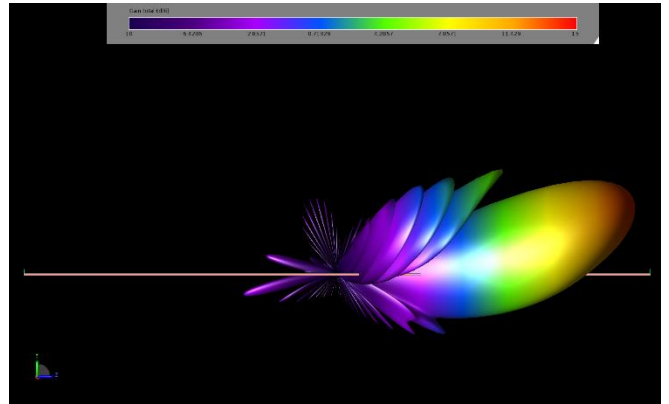
図20：12 GHzの3次元パターン
