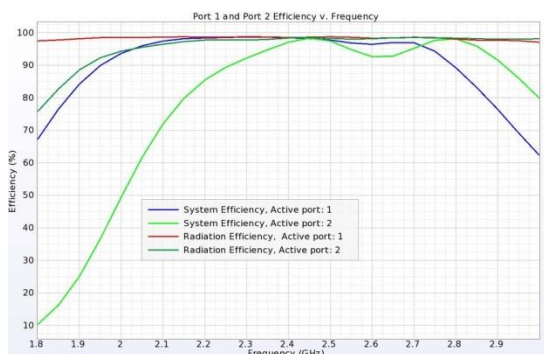
図19：広帯域アンテナの放射効率とシステム効率 この広帯域アンテナは非常に効率的で、対象となる帯域でミスマッチ損失含むシステム効率が100%近くになっている
