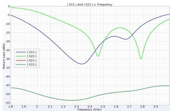
図17：広帯域アンテナのSパラメータ どちらのポートからの給電においても、2.25～2.8GHzの範囲でリターンロスが-10dB以下となり、対象となる帯域以上をカバーしている 2ポート間のアイソレーションは-45dB以下となっている
