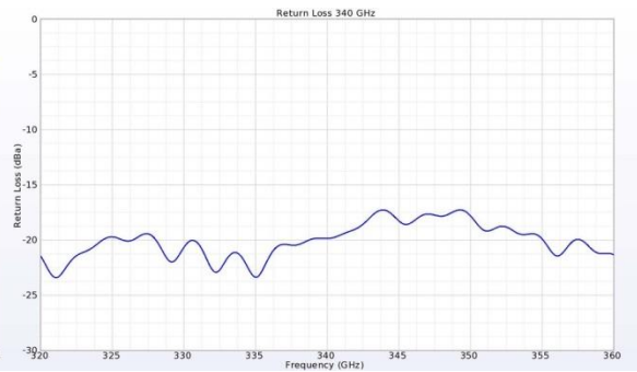
図5：高周波数側ポートでのリターンロス この帯域でリターンロスはほぼ-20dB
