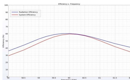
図6：アンテナの放射効率とシステム効率 金属製のアンテナに比べて損失が少ないため、60GHzで約60%と非常に良好
